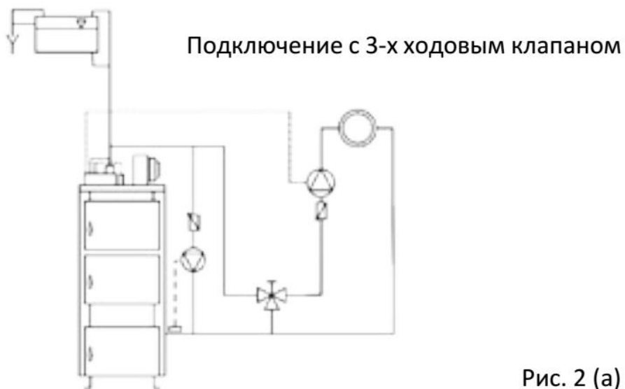
Подключение с 3-х ходовым клапаном и водонагревателем
